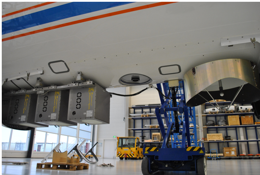
Abbildung 2.1: Messgeräte unter dem Rumpf von HALO. Zu sehen sind die drei Mikrowellenradiometermodule (links), das Sichtfenster des Lidars (Mitte) und das Wolkenradar (rechts) (Quelle: Friedhelm Jansen, Max-Planck-Institut für Meteorologie).
